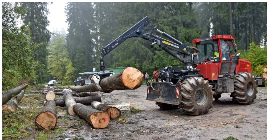
Beim Harzer Langholzverfahren wird das Holz lang an einen Aufarbeitungsplatz gerückt (unten). Dort werden die Stämme fertigentastet und die Sortimente ausgehalten (oben).
