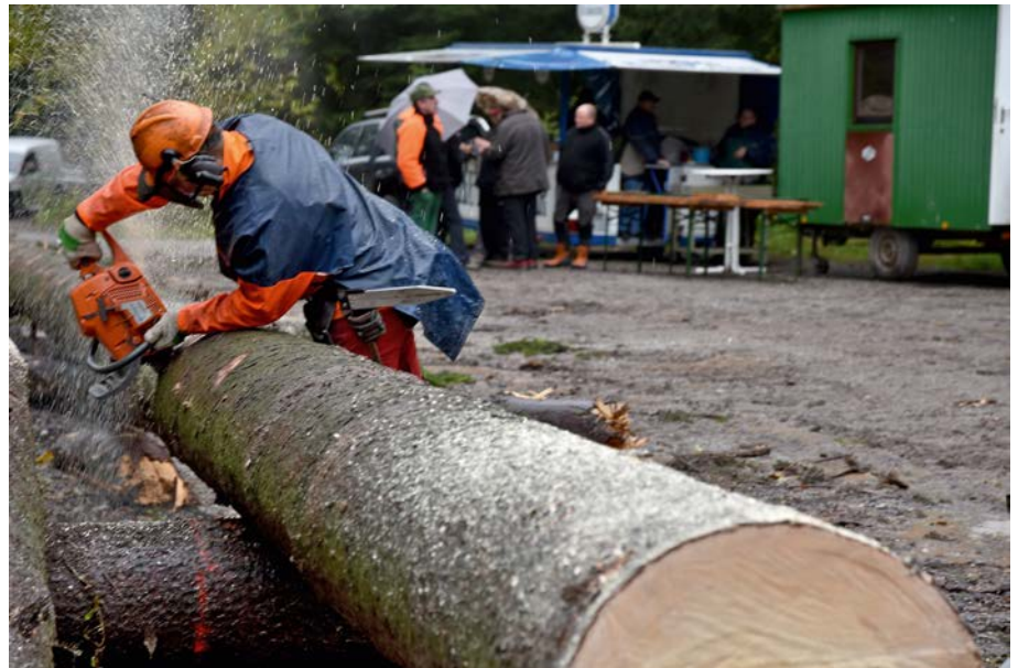
Beim Harzer Langholzverfahren wird das Holz lang an einen Aufarbeitungsplatz gerückt (unten). Dort werden die Stämme fertigentastet und die Sortimente ausgehalten (oben).
