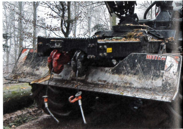
Das Rückeschild verfügt über hydraulische Hub- und Druckzylinder sowie die Möglichkeit der Schwimmstellung. Die Seilrollenwinde ist hydraulisch höhen-verstellbar bis auf gut zwei Meter.
