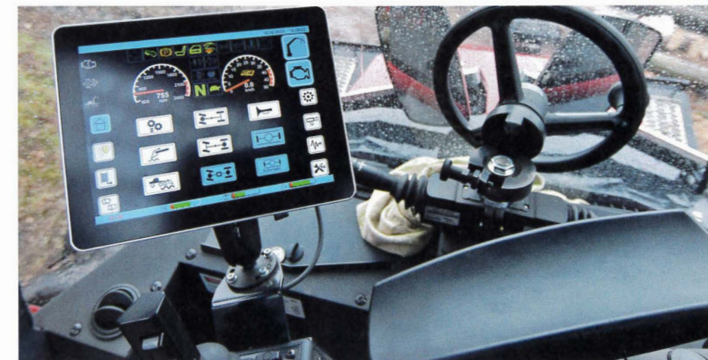
Alles im Blick: Das großzügige Touchdisplay ist seitlich an der Armlehne des Drehsitzes befestigt. Unten: Scheiben und Dachfenster der Lexanverglasung bieten eine gute Rundumsicht.
