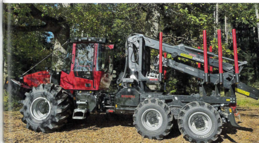
Mit Rungenkorb bereit für den Kurzholz-Einsatz, die hintere Runge ist teleskopierbar. Werksfoto
