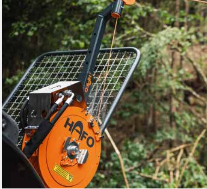
Das Ende des Hilfsseils am Windenseil inkl. Ketten befestigen.
